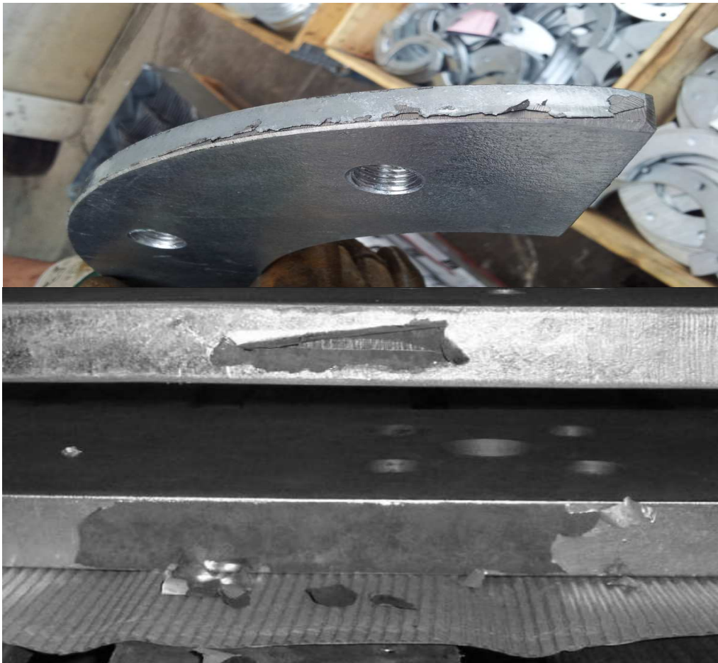
Delaminace povlaku žárového zinku na ploše řezu Hot dip zinc coating delamination on area of the cut
